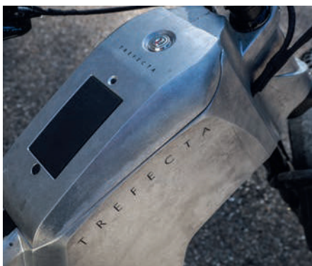
Im wuchtigen „Tank“ des Trefecta steckt ein riesiger 1480-Wh-Akku.
