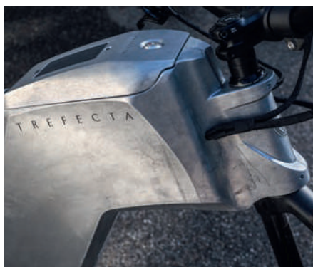
Der Rahmen besteht aus Hochdruck-Spritzguss-Aluminium aus dem Flugzeugbau.
